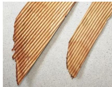
Dünnes Brett, parallele Rillen herausgefräst (Foto: Sandro Halter)
